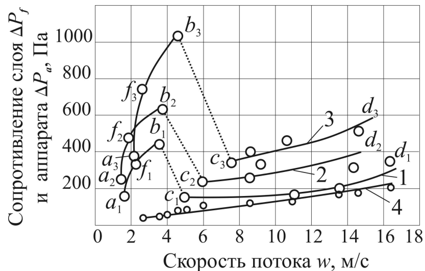
Рис. 4.3. Зависимость аэродинамического сопротивления слоя частиц \Delta P_f и корпуса аппарата \Delta P_a от скорости потока
