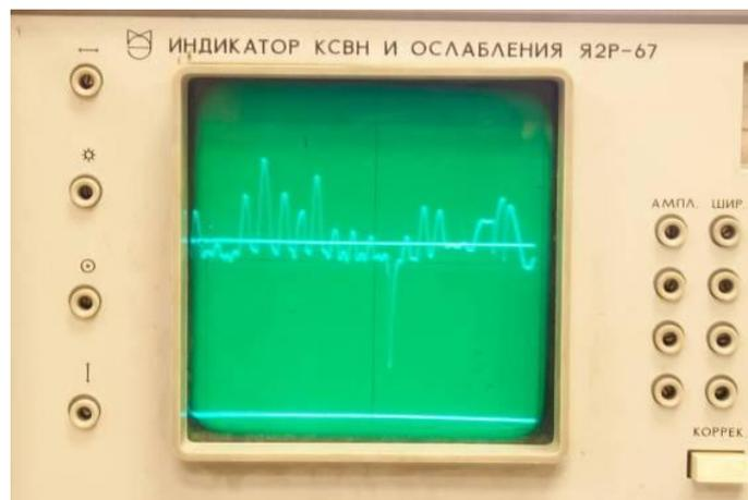
Рисунок 5.3 - Результат измерения. (Хорошо заметен резонанс).
