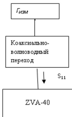
Рисунок 5.6 - Измерение коэффициента отражения. Способ М1
