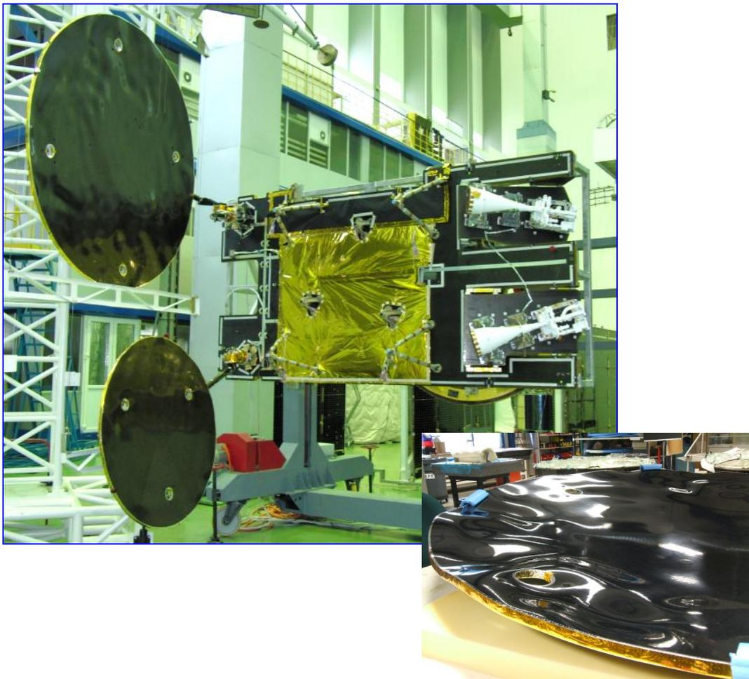
Рисунок 1.3 — Контурные антенны КА связи
