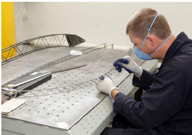
а) изготовление элементов силового каркаса
