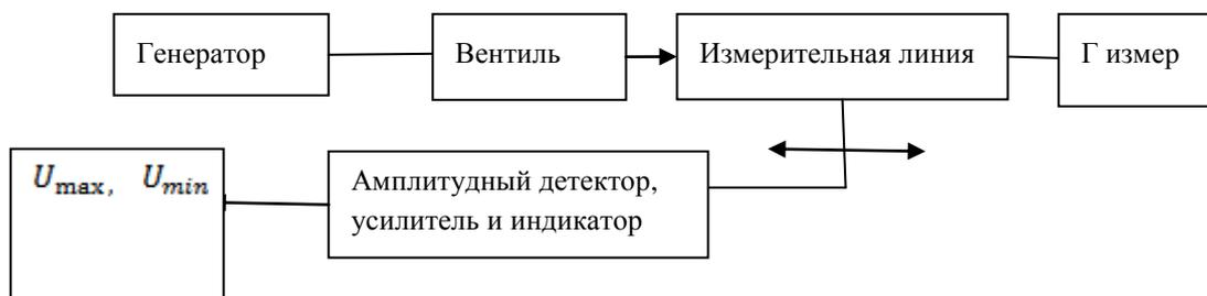
Рисунок 2.11 - Схема с использованием измерительной линии.
