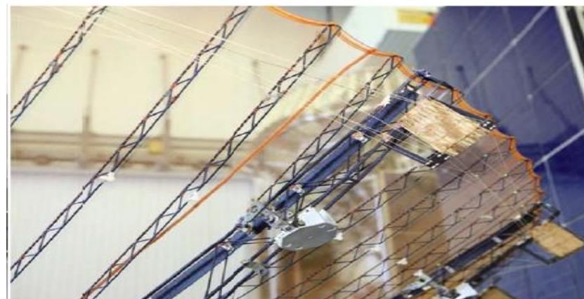
г) монтаж отражающей поверхности из сетеполотна
