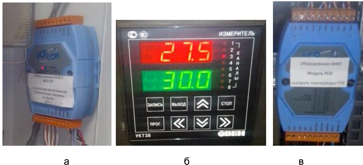
Рис. 2. а) контроллер УКТ-38; б) модуль ICPDAS I-7018; в) модуль ICPDAS I-7044
